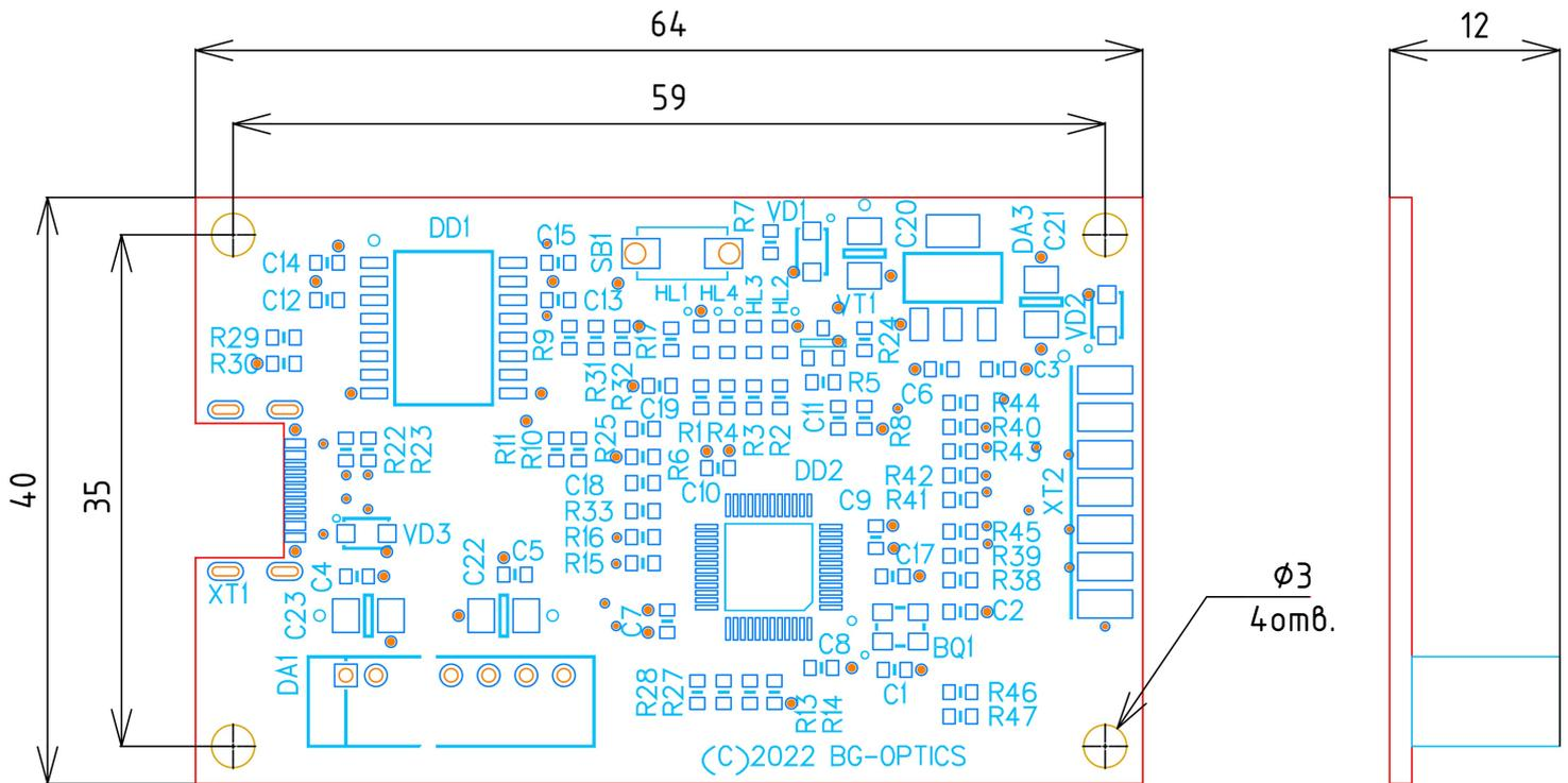
Модуль изготавливается в виде печатной платы с монтажными отверстиями. Исполнение без корпуса позволяет монтаж изделия в плату/шасси отлаживаемой системы.
