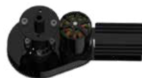
Двигатель с понижающим редуктором
