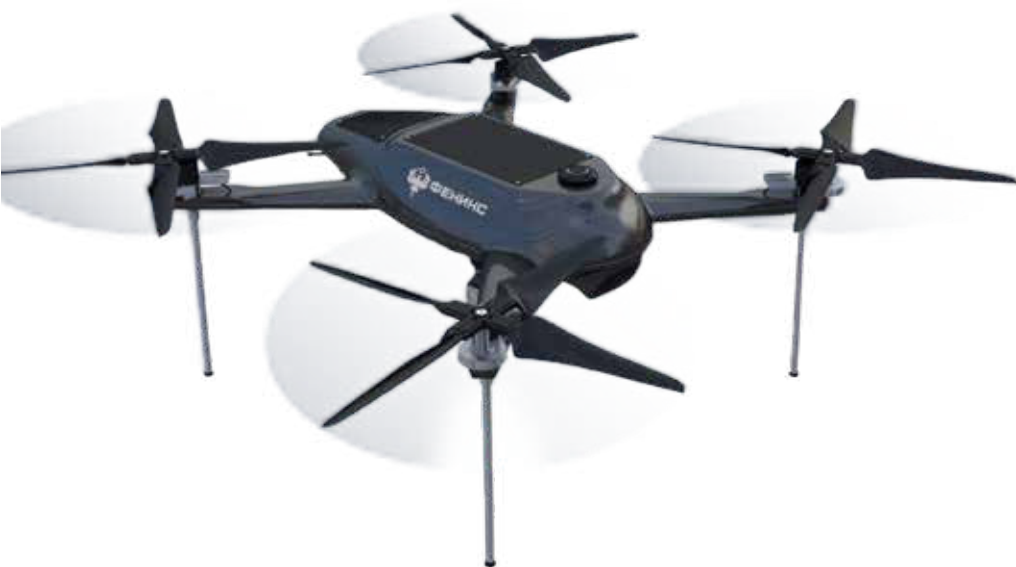
Корпус и лопасти из карбона
