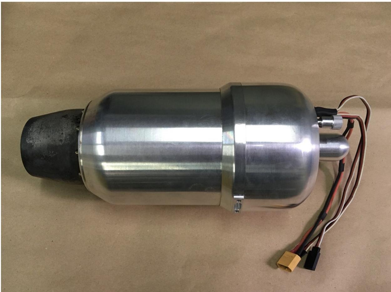
**Турбореактивный двигатель RJ-200** с тягой 20 кг при температуре окружающего воздуха не более 15 С° и расходом топлива на максимальной тяге 0.68-0.7 л/мин. ТРД имеет встроенный топливный насос, встроенную электронику управления, встроенные топливные клапаны. Для работы ТРД требуется только подвод топливопровода и электрокабеля.
