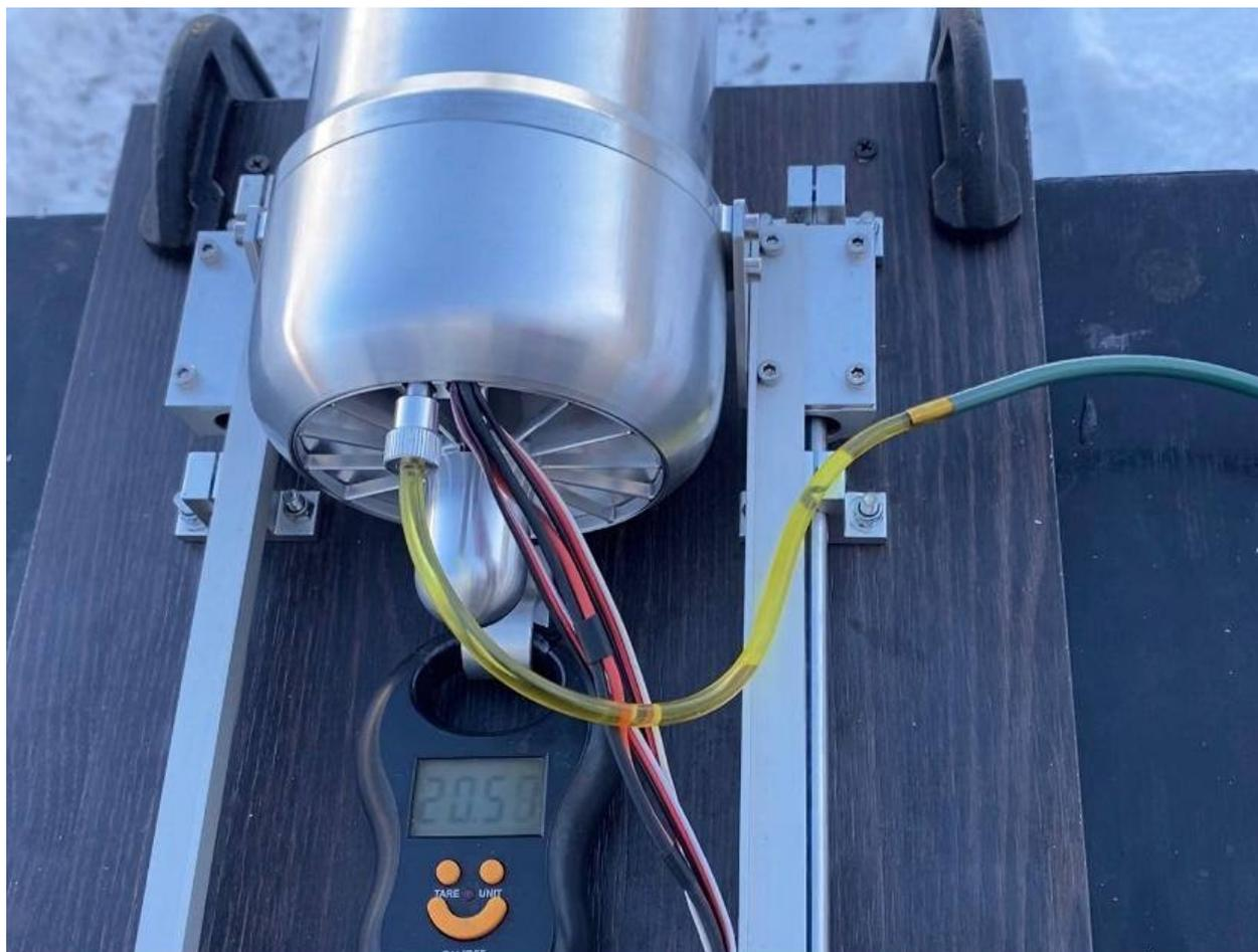
Двигатель на испытательном стенде, измерение силы тяги.
